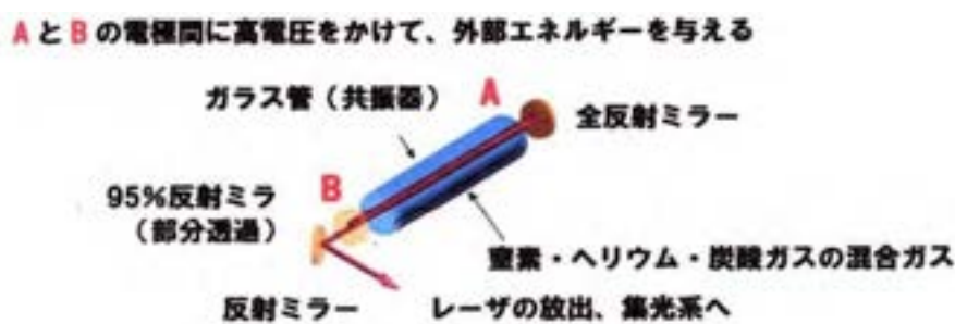
図 109: 炭酸ガスレーザー発生のメカニズム (株)レーザーワークス
