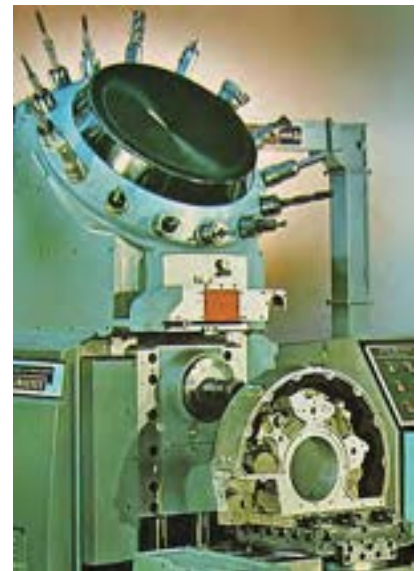
図 86：自動工具交換装置の仕組み (Kerney and Trecker Milwaukee Matic Series Eb)
