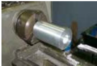
中ぐりバイトにより徐々に穴径を大きくする
