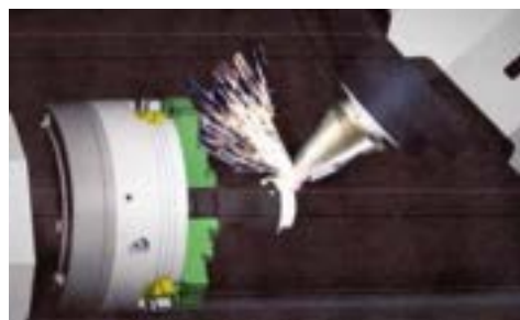
写真 9: 指向性エネルギー堆積(Directed Energy Deposition: DED)法
