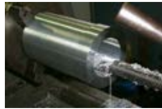
中ぐりバイトにより徐々に穴径を大きくする
