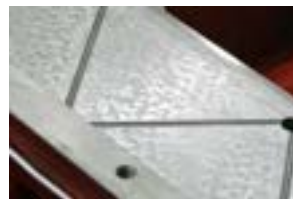
写真 3: 汎用工作機械案内面のきさげ加工
